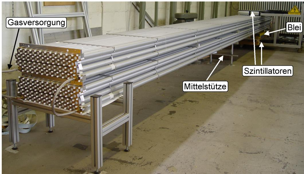
**Abbildung 4.1:** Teststand mit zwei 8 m-Driftröhren-Modulen
