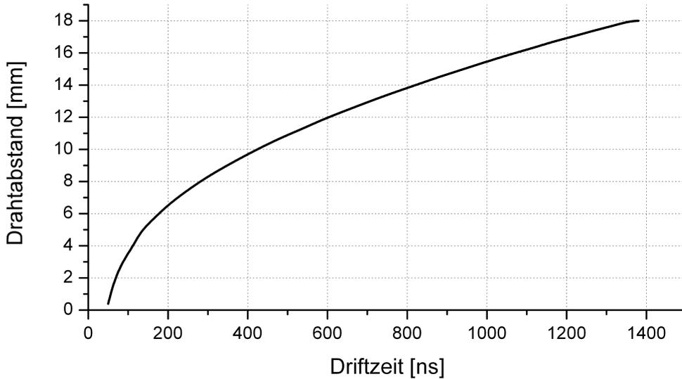
**Abbildung 4.6:** Driftzeit–Ort–Beziehung einer Messung am Teststand mit einer Anodenspannung von 2,35 kV und Diskriminatorschwellen von 50 mV
