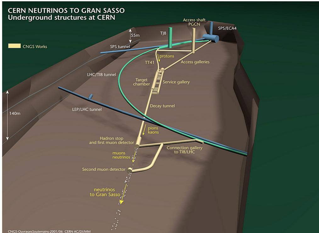
Abbildung 3.1: 3D-Darstellung der CNGS-Anlage am CERN (Quelle: CERN)
